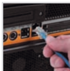
Ethernet Порт Подключение к Интернету для просмотра продукции или руководства пользователя, отправки данных осмотра по электронной почте
